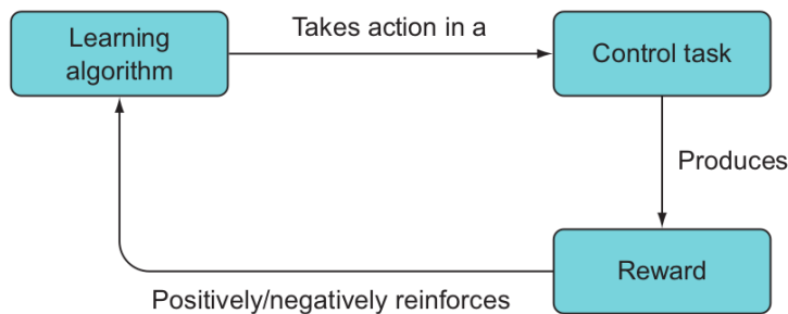
Figura 1.1.: Funcionamiento de los algoritmos RL: El agente inteligente interactúa con el entorno, toma decisiones (acciones) y recibe retroalimentación en forma de recompensas positiva o negativa en función de esas acciones [ZB20]
